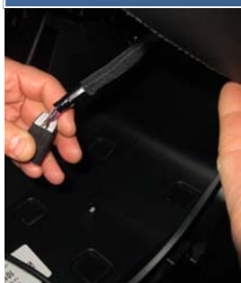
Abbildung 1: Foto von der Beifahrerseite aus zur Mittelkonsole, Stecker vom Wechsler unter dem Bildschirm (Wechsler ausgebaut)
