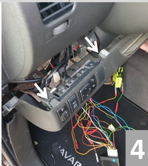
Verkleidung nach vorne abziehen Pull off the cover to the front
