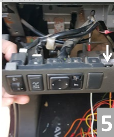
Schraube an der Schaltereinheit lösen Loosen the screw on the switch unit
