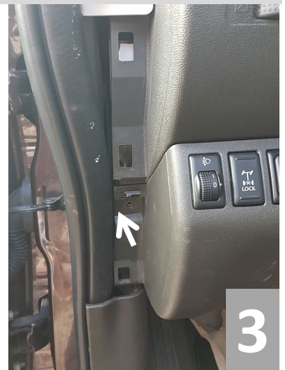
Schraube lösen Loosen screw
