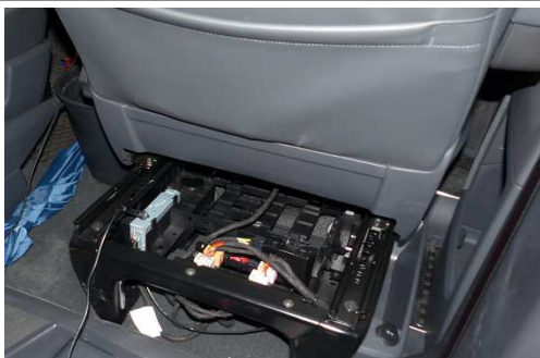
Abbildung 1: Fundort Stecker – unter Beifahrersitz
